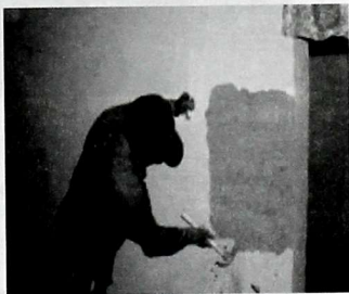
71-сүрөт. Дубалдардын белгилүү бөлүктөрүн бекемдөөдөн кийинки сыноонун жыйындыгында өзүнүн бышыктыгынын далили.
